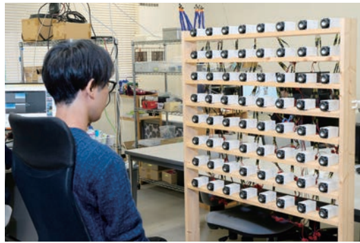
●スピーカーアレイ 視覚障害者の視覚に代わって音で物の動きを伝える 感覚代行システム被験者はスピーカーの前に着席する
