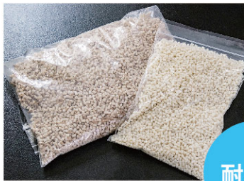
既存のプラスチックとPGAICを 練り込んだ原料
