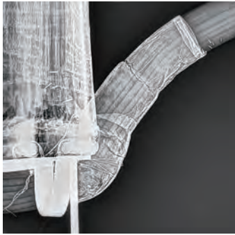
ツタンカーメンが乗ったとされる戦車のフレーム箇所のエックス線画像。一本の木材が45度曲げられている。
